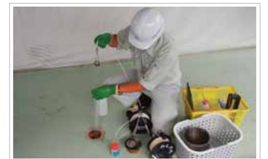
地下水の採水作業
