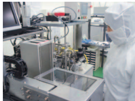
クリーンルーム内のLEDホワイトキャップ生産工程
